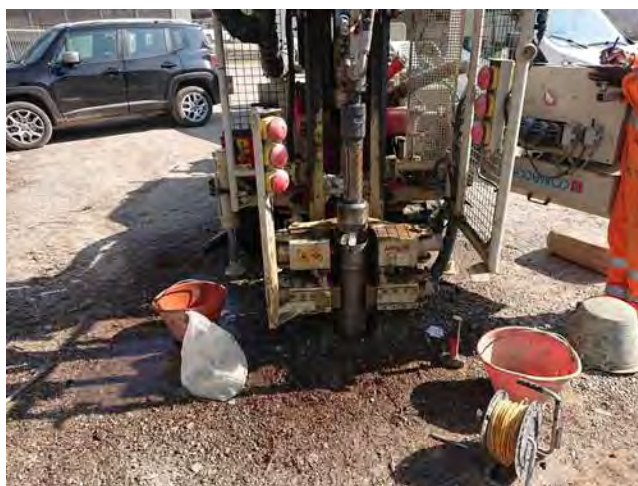
Esecuzione della prova con boccaforo a +0.5 m
